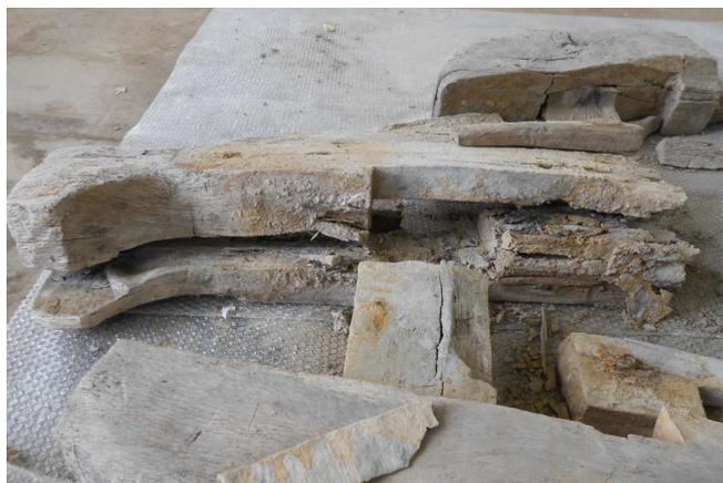
**Fig. 5:** Dettaglio della porzione inferiore dell'ancora con presenza di sabbia lungo le ammorsature tra i singoli elementi (foto di Andrea Gobbi)
