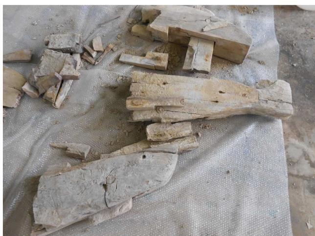
**Fig. 6:** Dettaglio della porzione inferiore dell'ancora con presenza di sabbia lungo le ammorsature tra i singoli elementi (foto di Andrea Gobbi)
